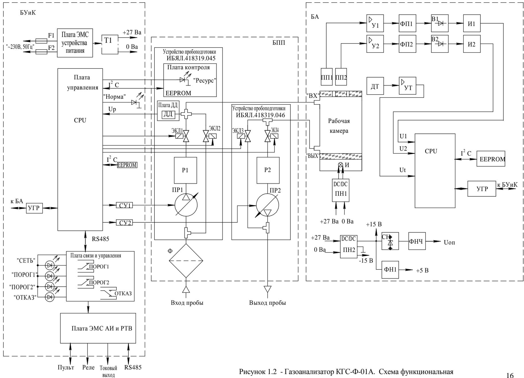
Рисунок 1.2 - Газоанализатор КГС-Ф-01А. Схема функциональная
