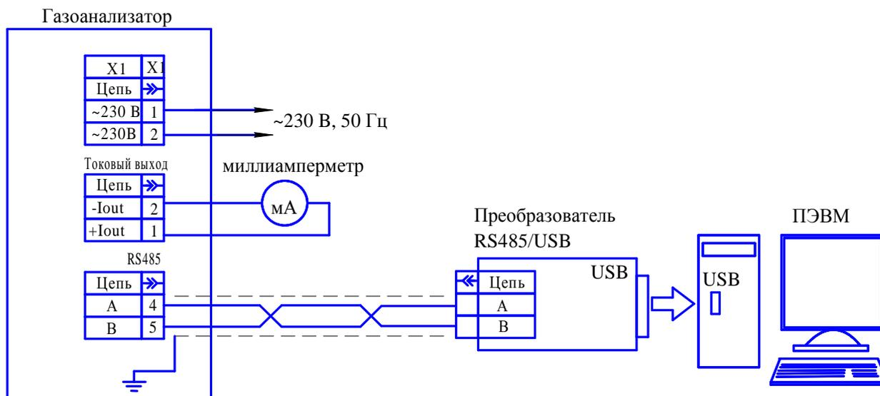
Рисунок 2.3 – Схема подключения газоанализатора к ПЭВМ
