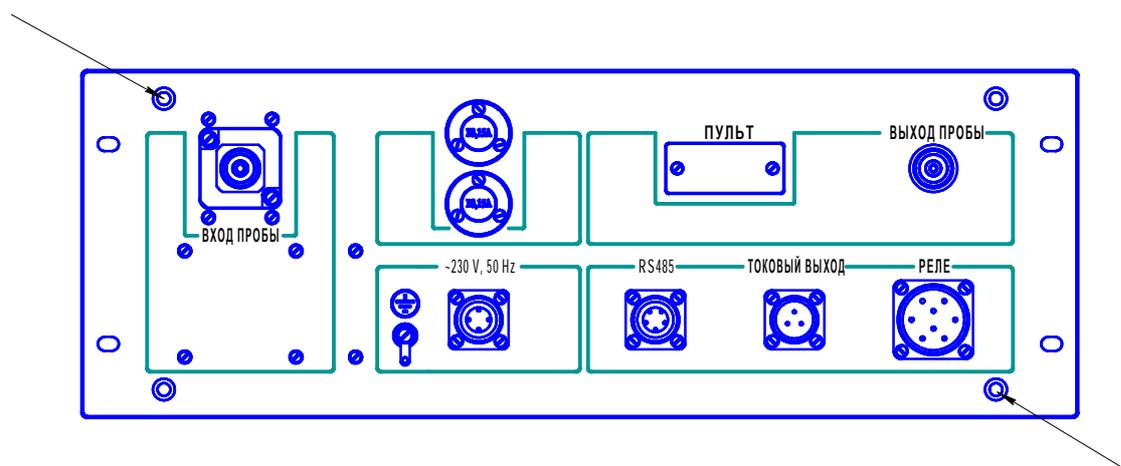
Стрелкой указано место пломбировки от несанкционированного доступа и обозначение места для нанесения оттисков клейм
